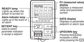
DATA display Displays a parameter setpoint or alarm type.
